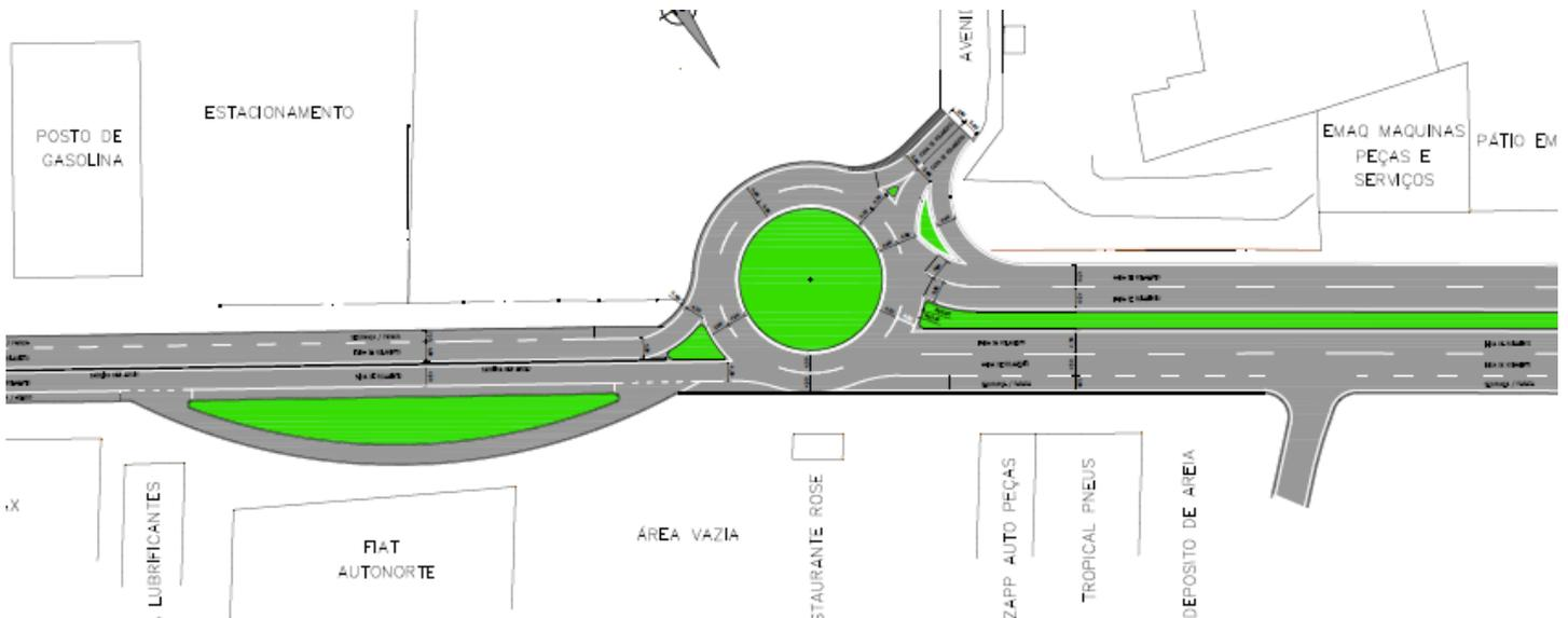
**Figura 1 - Interseção projetada para ligação entre as pistas simples e duplicada na Travessia Urbana de Barra do Garças**
