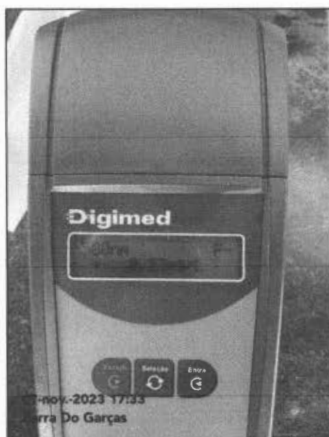
Imagem 02: Detalhe do resultado da análise do íon fluoreto na saída do RAP Mina Monjolo – 0,23 mg/l.
