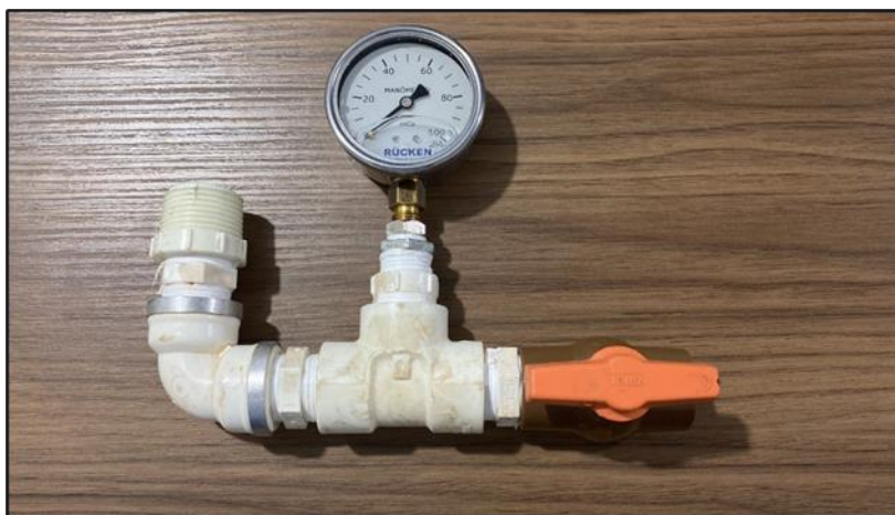
Imagem 01 – Foto do equipamento utilizado para aferição de pressão. Fonte: AGIRF.
