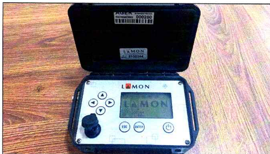
Imagem 01 – Foto do equipamento Datalogger LAMON DP 5100244. Fonte: AGIRF.
