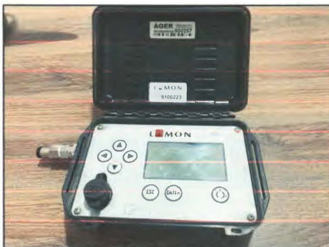
Imagem 01 – Foto do equipamento Datalogger LAMON DP 5100223. Fonte: AGERBARRA.
