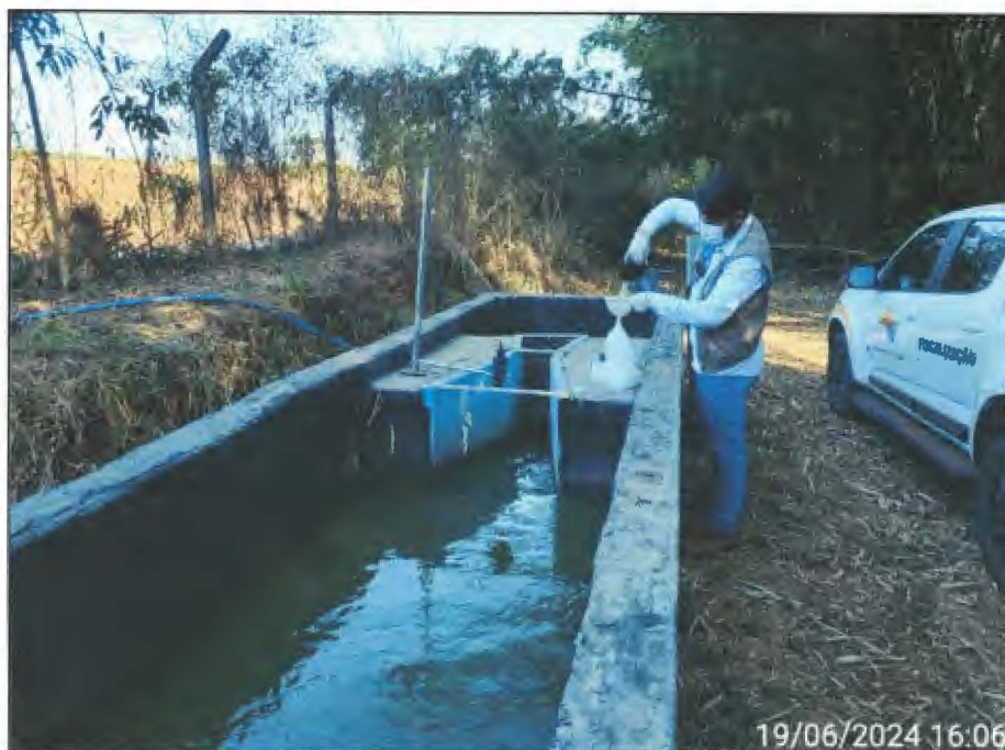
Imagem 02: Detalhe do momento da coleta da amostra do efluente tratado.
