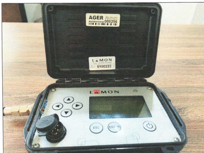
Imagem 01 – Foto do equipamento Datalogger LAMON DP 5100222. Fonte: AGERBARRA.
