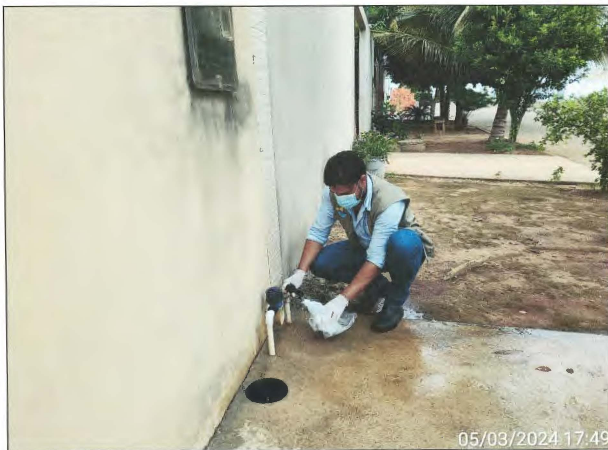
Imagem 01: Detalhe da coleta de amostra de água no cavalete da rua K, Greenville.
