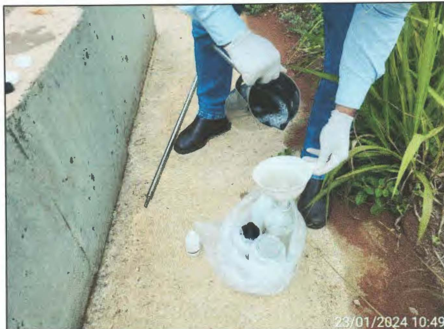
Imagem 04: Detalhe da coleta do esgoto tratado na saída da ETE Rio das Mortes – 23/01/2024.
