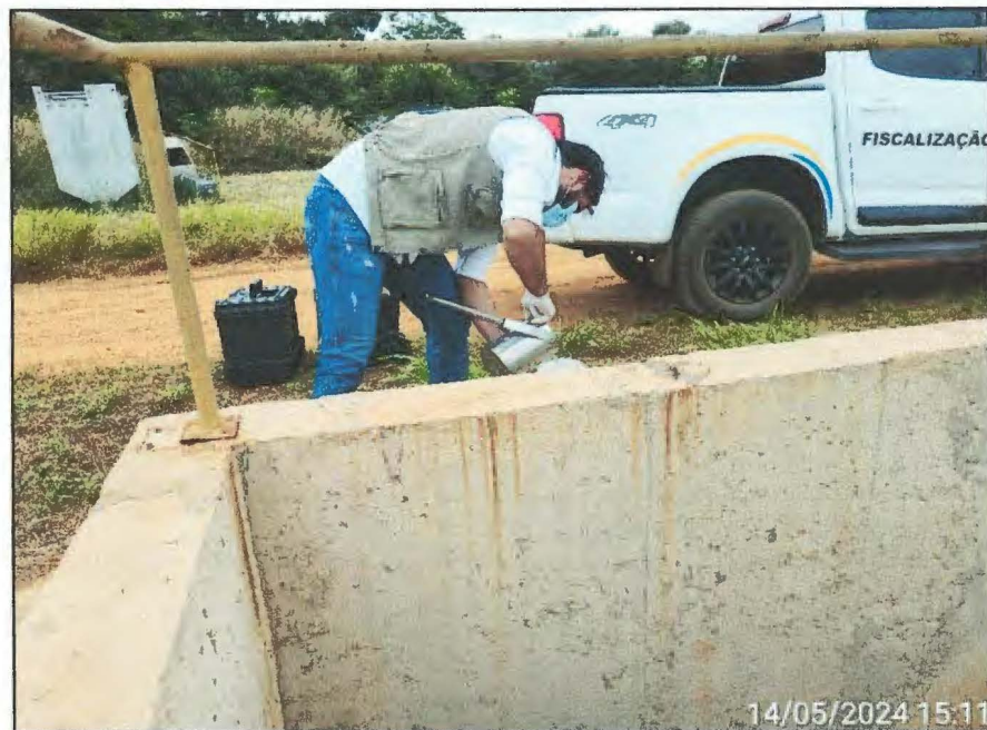
Imagem 08: Detalhe da coleta do esgoto tratado na saída da ETE Rio das Mortes – 14/05/2024.
