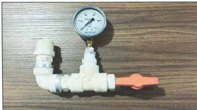
Imagem 01 – Foto do equipamento utilizado para aferição de pressão. Fonte: AGERBARRA.
