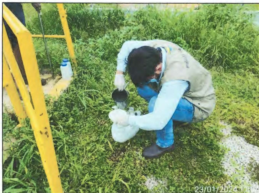
Imagem 02: Detalhe da coleta de esgoto bruto na chegada da ETE Rio das Mortes – 23/01/2024.
