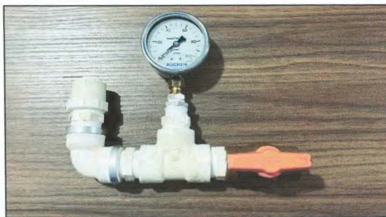
Imagem 01 – Foto do equipamento utilizado para aferição de pressão. Fonte: AGERBARRA.
